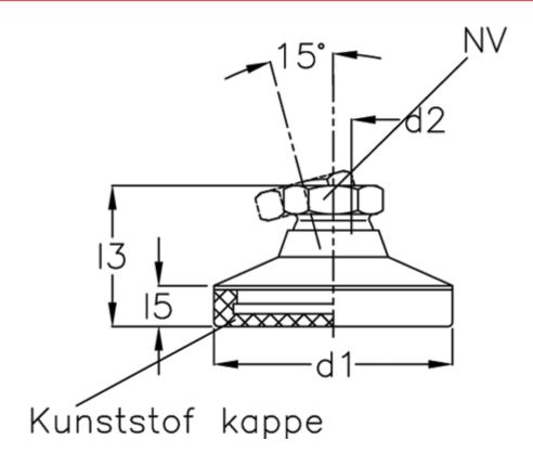
d1 = 50 d2 = 10 l3 = 29.5 l5 = 8.5 NV = 15 Static load (N) = 11 t min = 10.5
